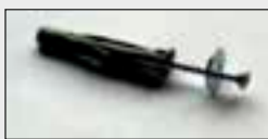
Tassello FU 8x50 (Plug) l. 50 mm, punta ø 8 mm
