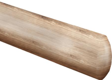
Paracolpi WB.125 convesso con finitura leggermente gofrata, in Life-Blend® con finitura effetto legno DIP-PRINT®, con struttura in alluminio, altezza 125 mm, ad assorbimento elastico d'urto, non tossico, antibatterico. Installabile anche su pareti in cartongesso a doppia lastra.
